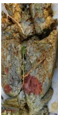
Horizon réductique mis en évidence par l'orthophénanthroline
